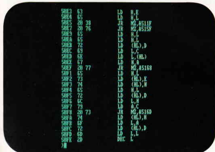
Bild 2: Mit DISASS wird ein Disassembler aufgerufen.
