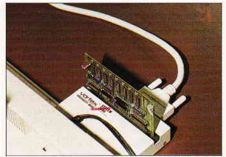
Bild 3: Kommt mit neuen Betriebssystemen: Das Personality-Modul für die PCWs
